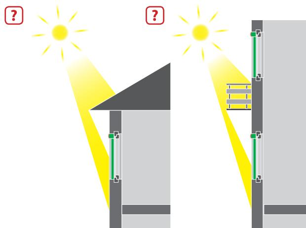
Markýzy ve verzi Solar by měly být instalovány v místech, kde bude solární panel bezprostředně vystaven přímému slunci. Solární markýzy se doporučuje instalovat na jižní, západní nebo východní straně. Při montáži na severní straně může dojít k vybití akumulátoru a výrobek nebudé možné ovládat. Abi byla zajištěna správná funkce automatického programu, musí být solární panel vystaven přímému slunci po celou dobu aktivní činnosti programu.
